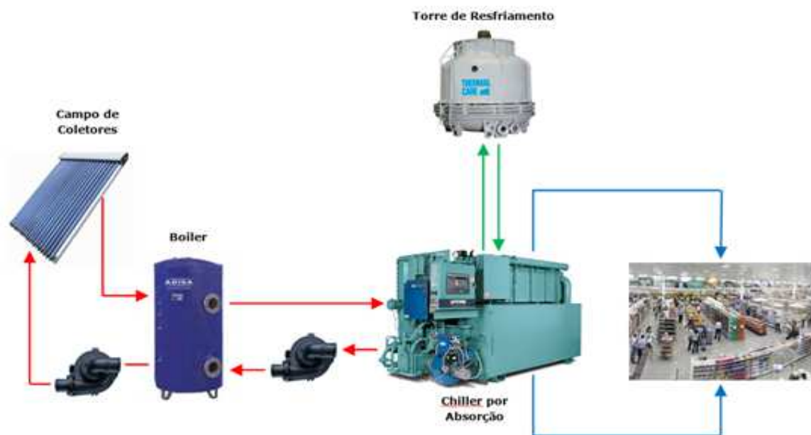
Figura 4-2 - Configuração básica do sistema de climatização solar proposto
